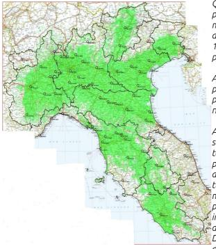
Questo nuovo sistema digitale permette la diffusione pubblica di molti canali radiofonici in qualità CD, sia monofonici che stereo utilizzando due bande di frequenze: da 174 a 239 MHz e la banda L (non in Italia) da 1452 a 1490 MHz per i servizi multimediali e di traffico, a pagamento.
